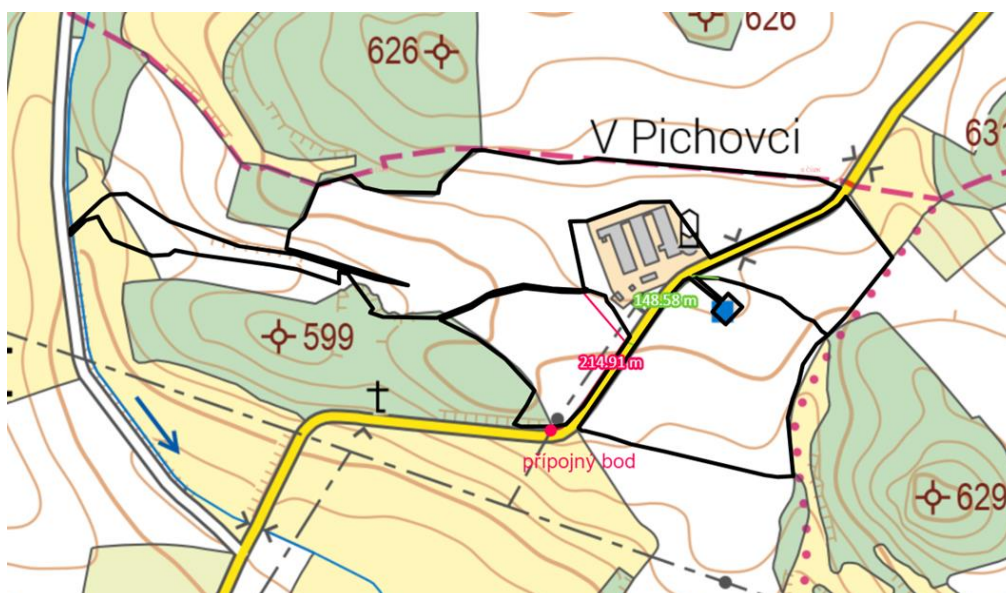
Obr.2: Mapka s návrhem přípojné trasy, připojujeme se na sloup vysokého napětí
